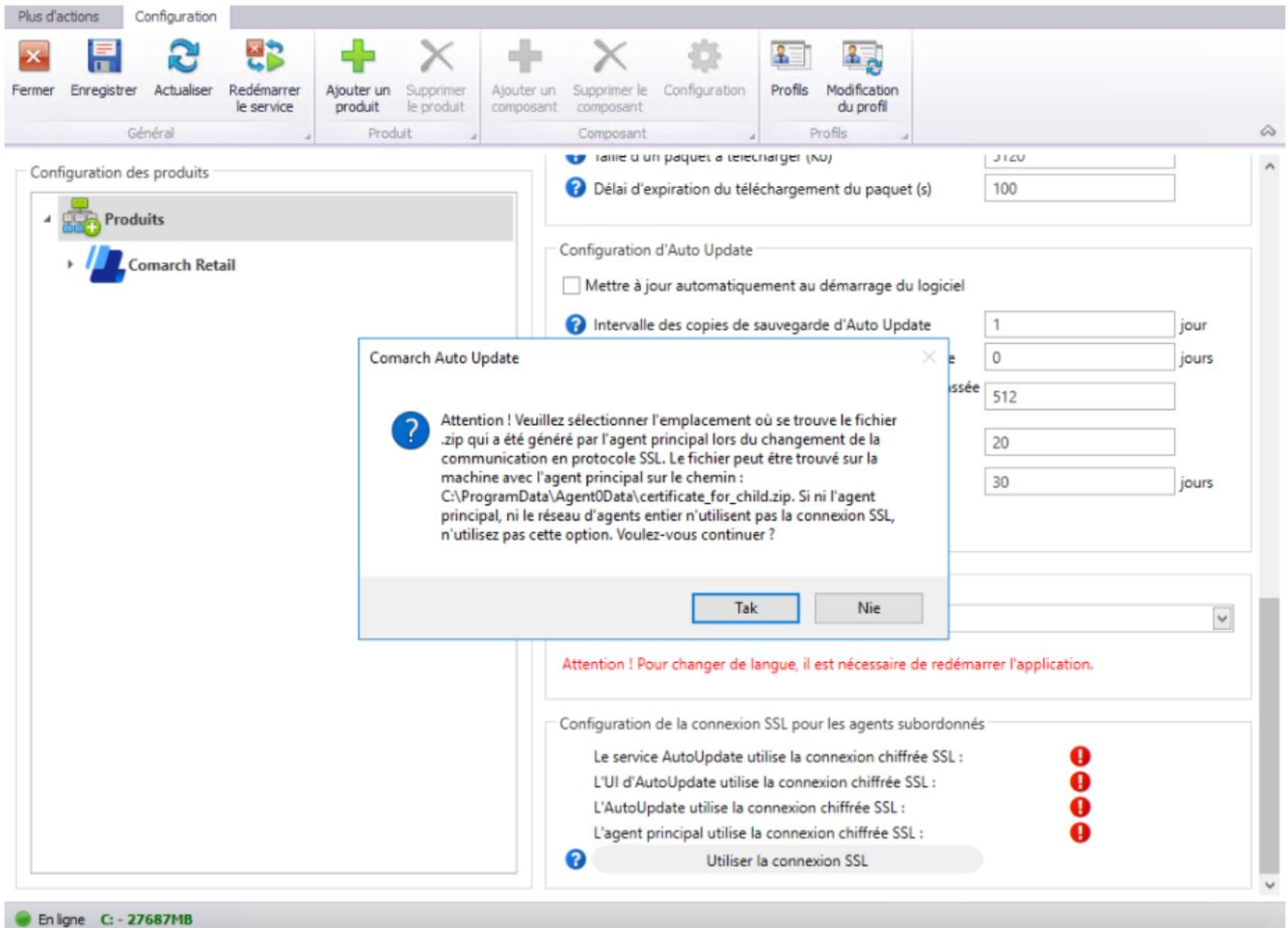
Message affiché lorsque le bouton [**Utiliser la connexion SSL**] est sélectionné
