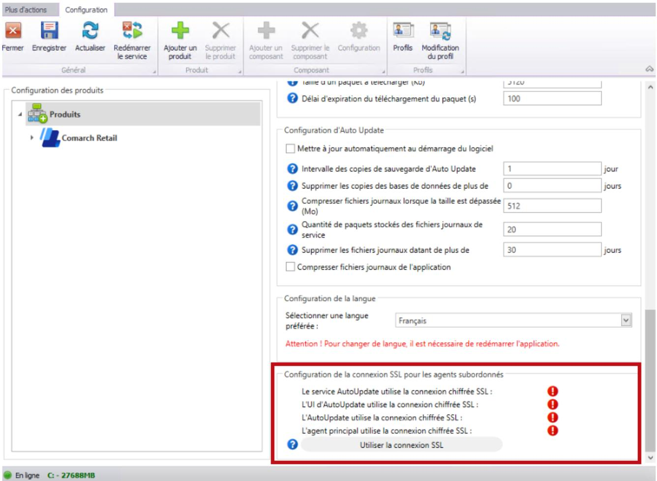
La section Configuration de la connexion SSL pour les agents subordonnés disponible à partir de l'onglet Configuration
